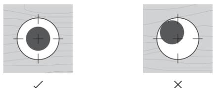
È anche molto importante che la testa del fissaggio sia completamente parallela alla superficie del pannello. Assicurarsi che la testa del fissaggio non eserciti una pressione eccessiva sul pannello e permetta il suo movimento a causa delle dilatazioni.
