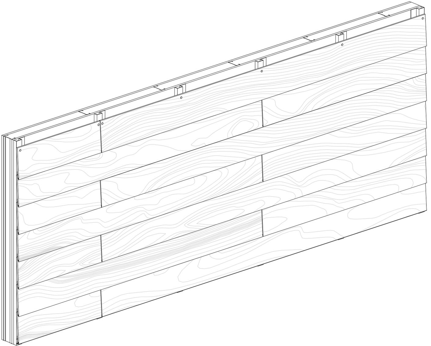
**SYSTÈME DE BARDAGE À RECouvreMENT
