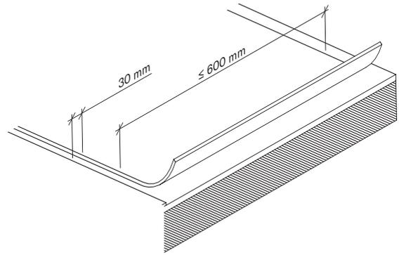
Aplicar una línea continua de adhesivo elástico de un extremo a otro entre las ranuras, sobre la superficie preparada del subsuelo, de acuerdo con las instrucciones del fabricante del adhesivo. Consultar al departamento técnico de PARKLEX PRODEMA para obtener las instrucciones más recientes sobre la aplicación del adhesivo.
