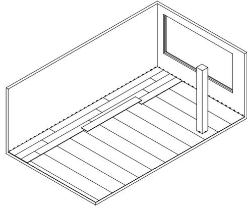
Retirar las cuñas temporales después de 24 horas y colocar un rodapié con un grosor adecuado para cubrir las juntas perimetrales.
