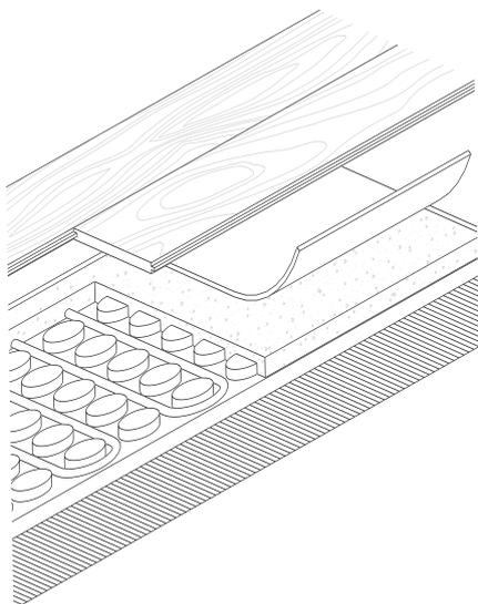
La humedad y la temperatura del suelo son los dos factores claves que se deberán controlar para que el suelo flotante funcione correctamente. Antes de poner en marcha el sistema de calefacción, hay que comprobar que la solera cumple las condiciones necesarias descritas anteriormente.
