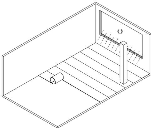
Después de colocar las líneas de adhesivo, deben colocarse cuñas temporales de  $\geq 8\text{ mm}$  en el perímetro, junto a las paredes u otros puntos fijos, para permitir la futura expansión/contracción.
