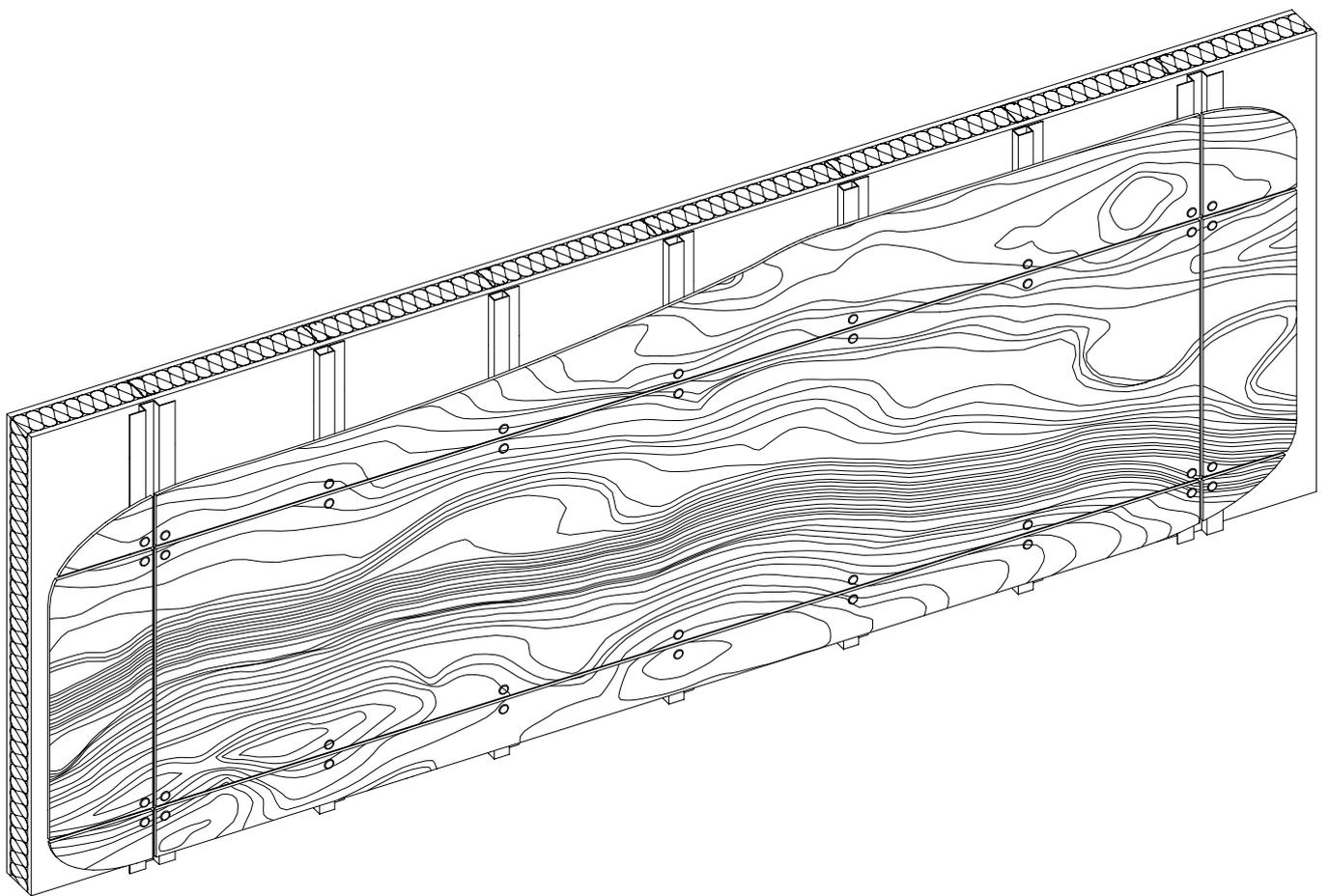
**FIJACIÓN VISTA CON TORNILLO O REMACHE
