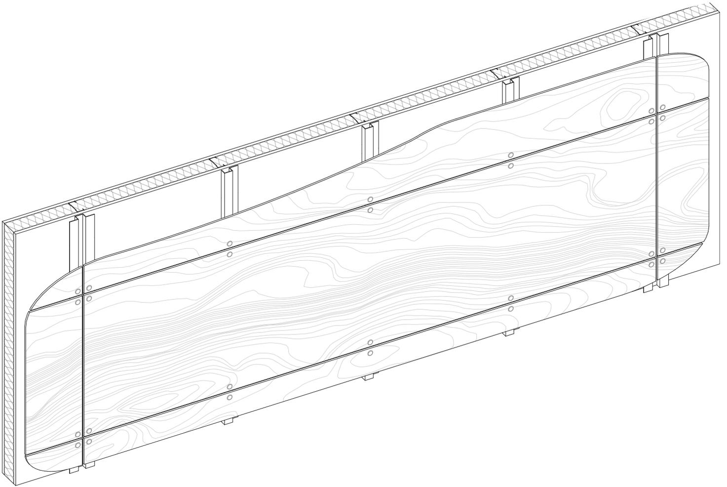
**FIJACIÓN VISTA CON TORNILLO O REMACHE
