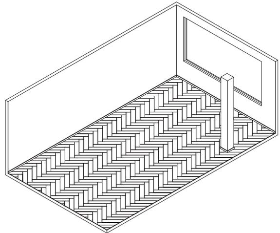
Transcurridas 24 horas, retire el calce temporal del perímetro e instale un rodapié de espesor adecuado para tapar las juntas perimetrales.
