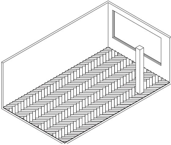
Para afianzar el adhesivado de la cola espatulable conviene colocar peso encima de las lamas instaladas hasta que polimerice el adhesivo.
