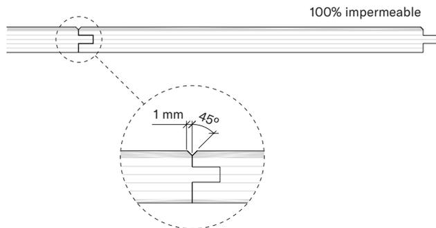
Este sistema de instalación requiere de dos tipos de lamas en función de su colocación. Es decir, tendremos lamas de izquierdas cuando se coloquen en la parte izquierda (pieza 1 en la ilustración) de la espiga y de derechas cuando se coloquen en la parte derecha (pieza 2 en la ilustración). Se recomienda ordenar las piezas en dos pilas diferenciadas al inicio de la instalación para que luego su colocación sea más sencilla.
