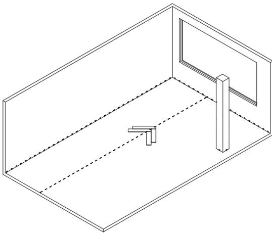
Una vez montadas las primeras piezas, se ha de extender la cola espatulable en la solera. Se alinea una de las puntas con el cordel, y se aplica adhesivo espatulable allí donde se vaya a posicionar las primeras laminas.
