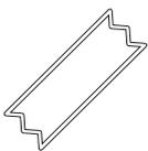
Coloque la manta de aislamiento en sentido transversal al de la lama. La manta de aislamiento actúa como aislante acústico y ofrece protección contra la humedad, absorbiendo pequeñas irregularidades de la solera. La manta de aislamiento tiene que llevar incorporada una barrera anti-humedad.
