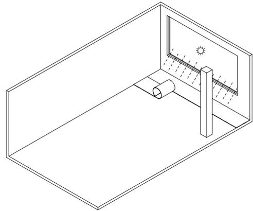
Durante el proceso de instalación, deben colocarse cuñas temporales de  $\geq 8$  mm en el perímetro, junto a las paredes u otros puntos fijos para permitir la futura dilatación/contracción.
