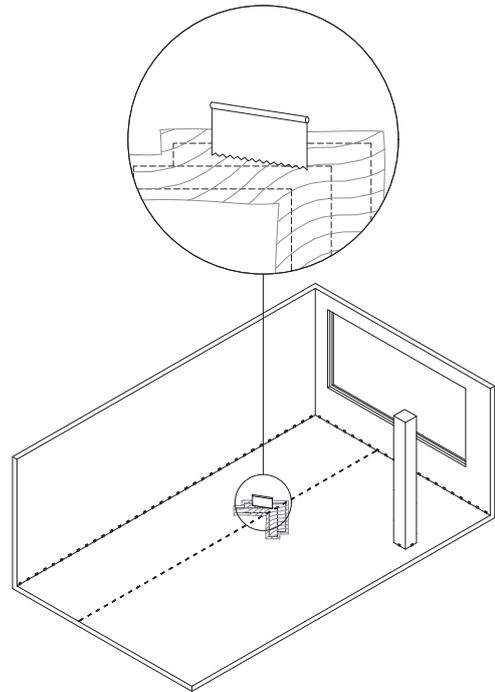
Extienda el adhesivo espatulable para colocar las siguientes laminas una detrás de otra. Repetir la aplicación del adhesivo PVA D3/D4 y proseguir con la instalación.
