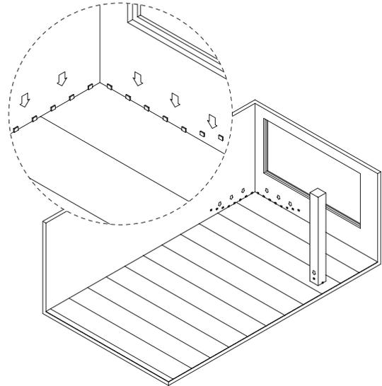
Se montan cuatro piezas con los machos mirando hacia el interior de la espiga. Se aplica a continuación cordones continuos de adhesivo PVA D3/D4 en el interior del borde superior de la hembra.
