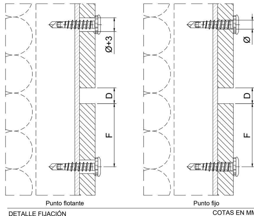
DETALLE FIJACIÓN COTAS EN MM
