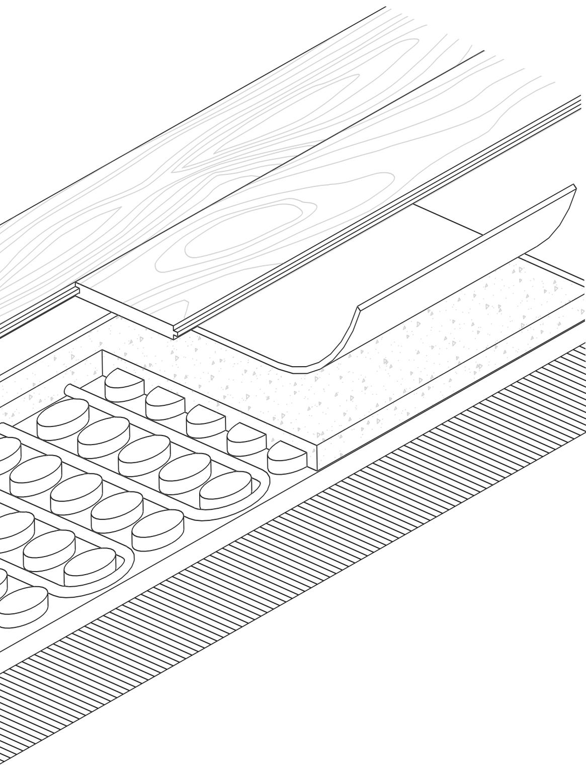
**INSTALACIÓN DE SUELO FLOTANTE
