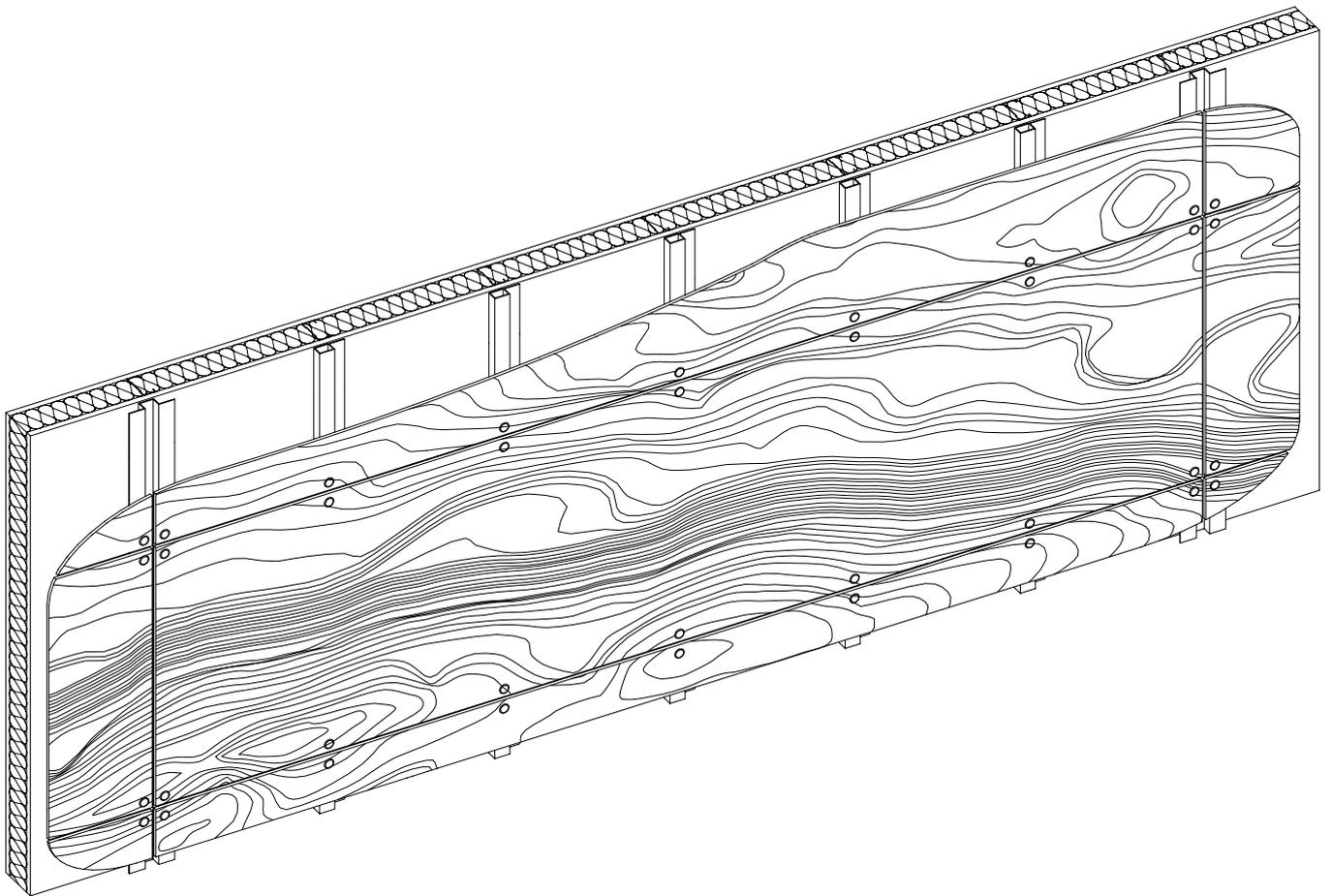
**OFFENE BEFESTIGUNG MIT SCHRAUBEN ODER NIETEN
